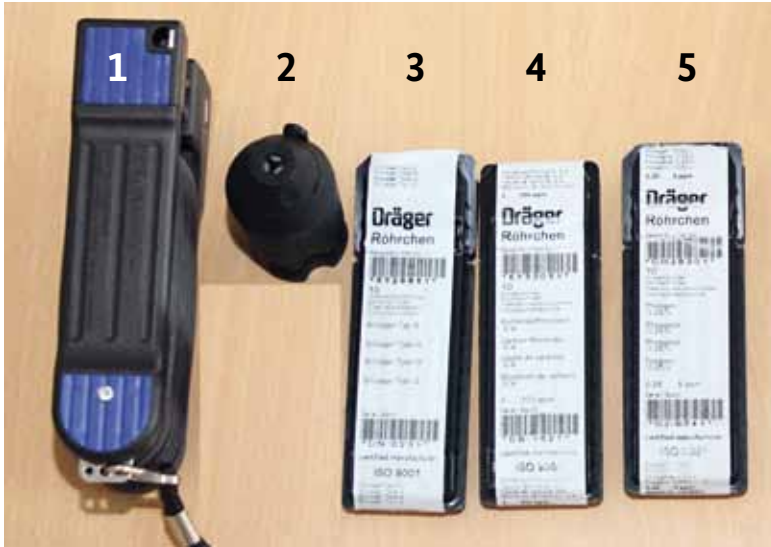
Abb. 14: CBRN-Ausstattung Bund mit Handpumpe (1) und Röhrenöffner (2), Sammelröhrchen Silikagel (3) sowie direktanzeigende Kurzzeitmessröhrchen für Kohlenmonoxid (4) und Phosgen (5)
